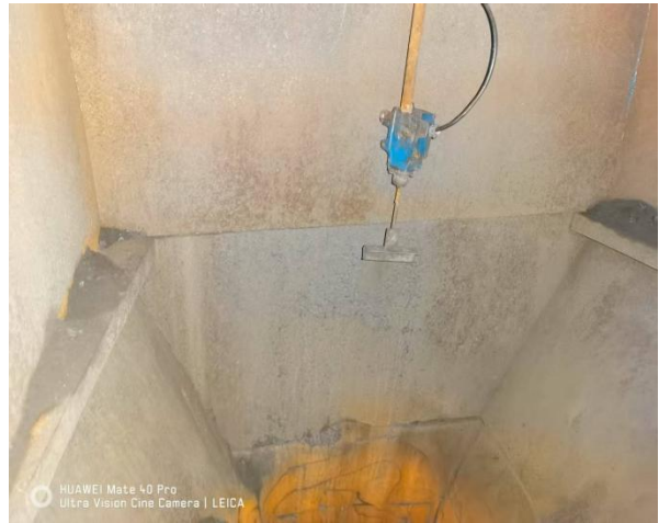
204 带式输送机急停开关、防堆煤保护装置（图 1-8）
