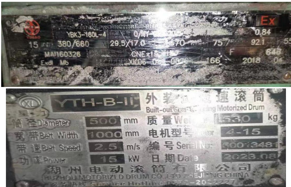
204 带式输送机电机、滚筒铭牌（图 1-4）
