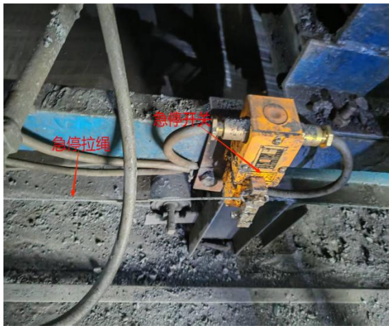
204 带式输送机急停开关、防堆煤保护装置（图 1-8）
